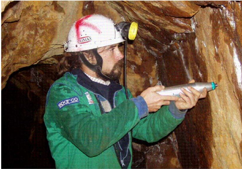
Medidas esclerométricas en el interior de la mina de Bustarvejo.
