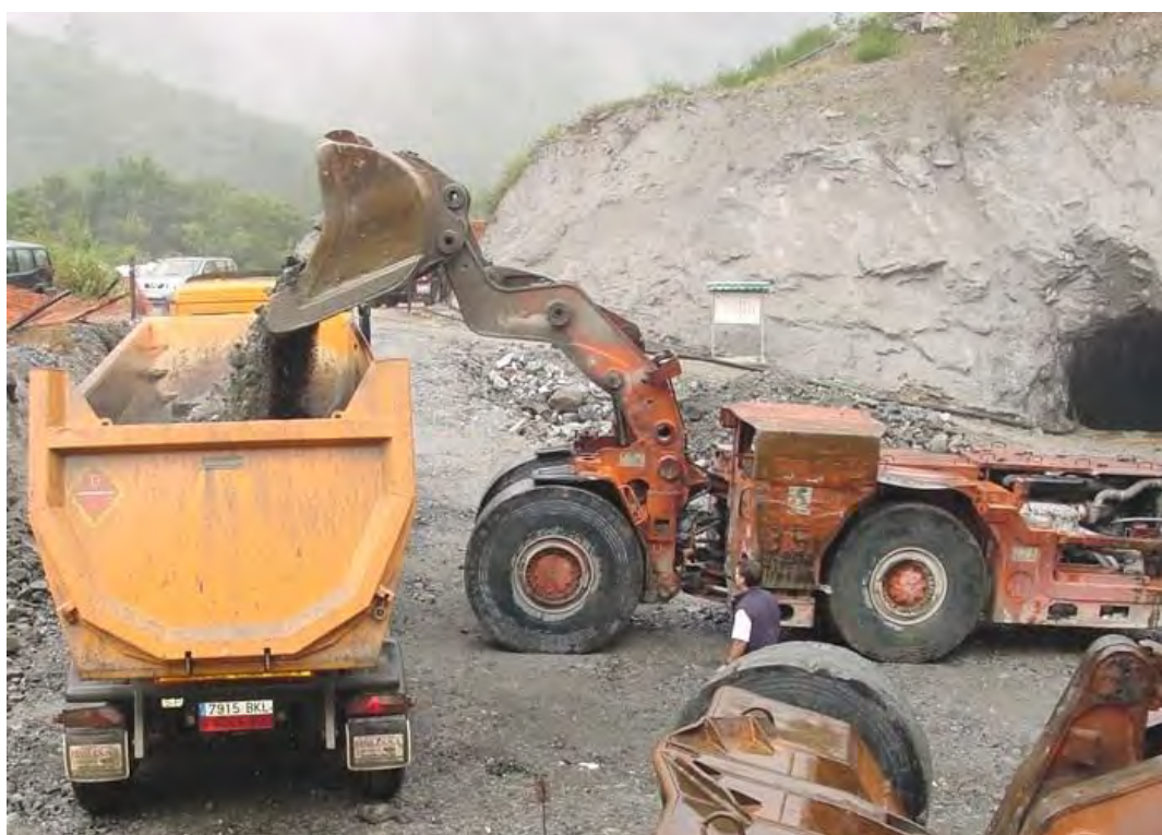
Fig. 39. El mineral era cargado sobre camión para su transporte a la planta de tratamiento de Boinás. Este transporte hacía que la ley de corte del mineral se incrementase para asumir dicho coste (Fuente RNGMSA).
